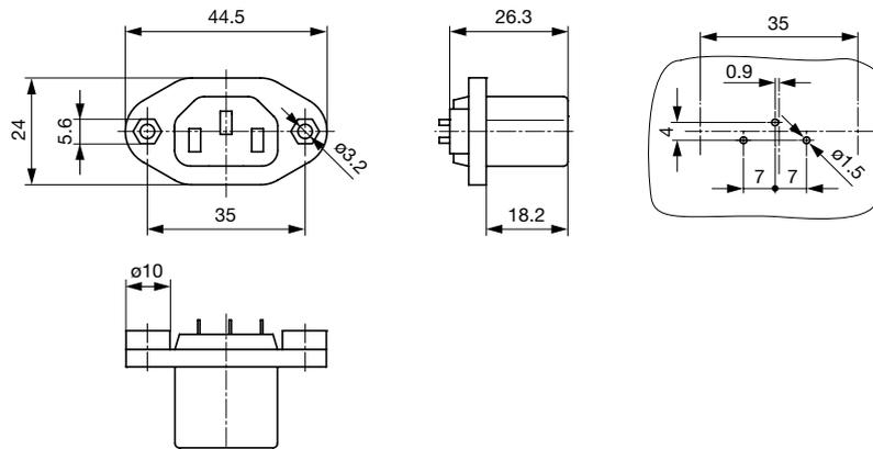
Montageflansch mit Durchgangslöchern Sonderausführung
