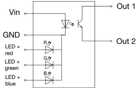
Abhängig von der gewählten Versorgungsspannung (5 - 28 VDC) müssen die Vorwiderstände für die LEDs gewählt werden (max. 20 mA Nennstrom)
