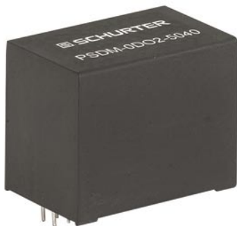
PSDM-60 (Datenübertragung über Optokoppler)
